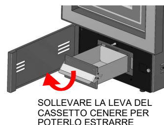
FIGURA 17 – Rimozione delle ceneri
